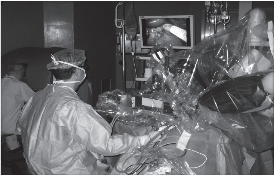
Figura 5. Sistema robotico Da Vinci ® allestito presso le camere operatorie della AOU San Luigi. Il primo operatore (a sinistra) non è sterile e lavora alla console del sistema. Il primo aiuto lavora al fianco del paziente. Si notino il monitor ed i bracci robotici.
